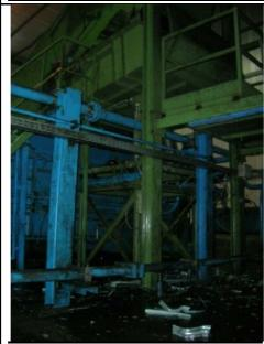
Riesgo de atrapamiento. Al estar trabajando con la máquina en movimiento, el operario se puede resbalar y al apoyarse para no caerse, se puede atrapar, para ello se debería aumentar la altura del carril de los paquetes.
